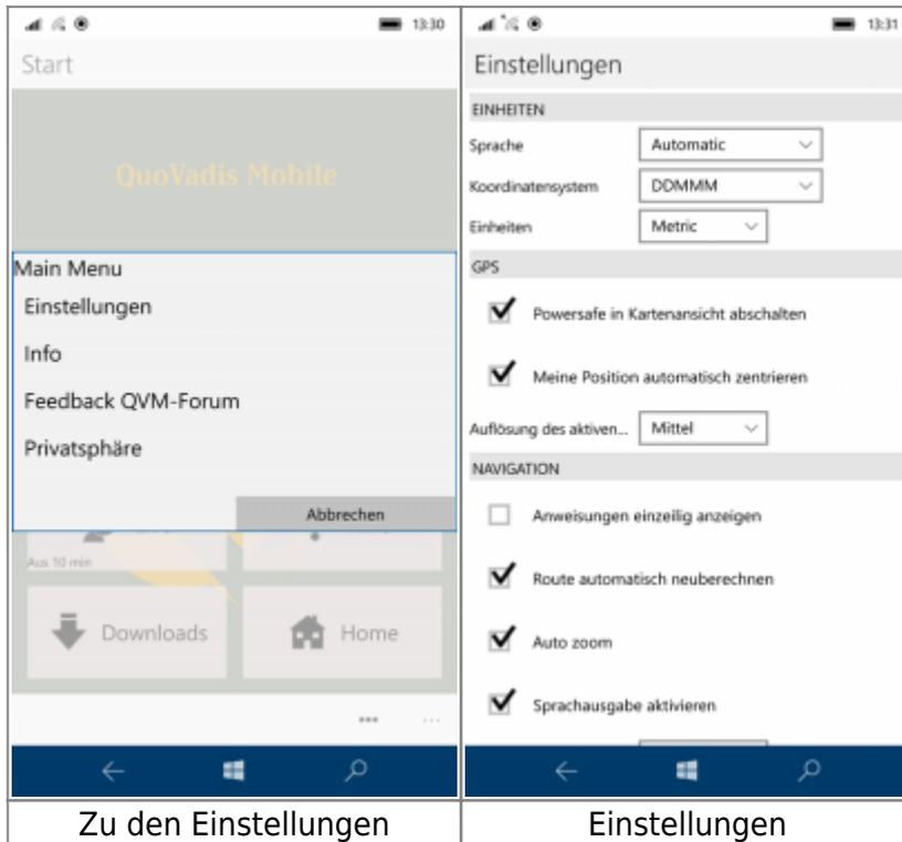
Unter **EINHEITEN** wählen Sie zwischen den verschiedenen Anzeigemöglichkeiten des Koordinatensystems DDDDD DDMMM DDMMSS UTM und der Einheit Metrisch Nautisch Englisch.
